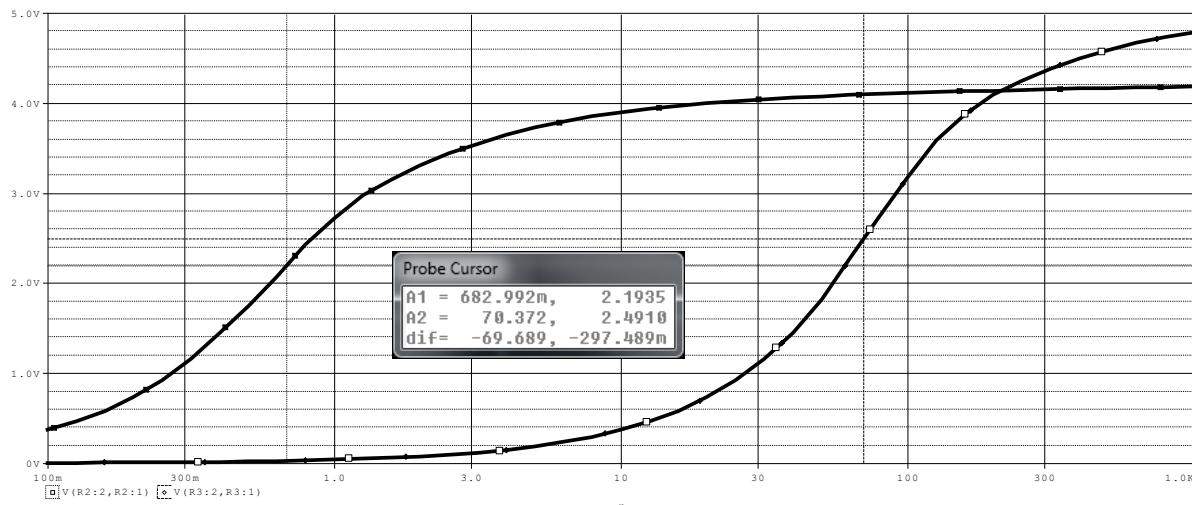
Pomoću kursora se uočava da je u slučaju baferisanog invertora izlazna otpornost  $\approx 70/100 = 700m\Omega$ .
