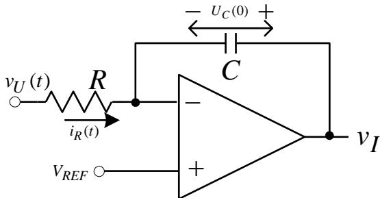
Na slici je prikazana električna šema Milerovog integratora. Sastoji se od operacionog pojačavača, i komponenti kao na slici.
