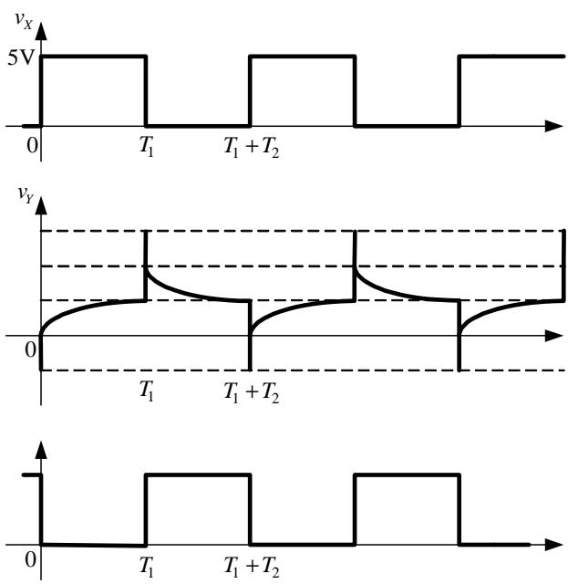
**6. a)** Prekidač je zatvoren za  $Q_i = 0$ , a otvoren za  $Q_i = 1$ .
