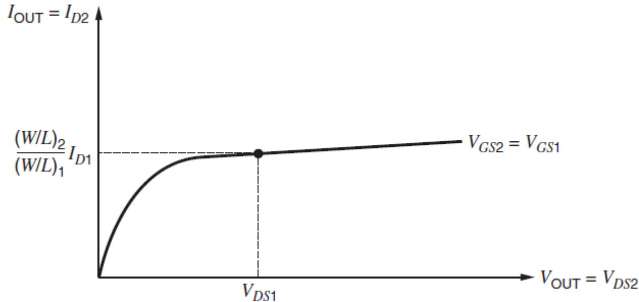
$$I_{\text{OUT}} = \frac{(W/L)_2}{(W/L)_1} I_{\text{IN}} \left( 1 + \frac{V_{DS2} - V_{DS1}}{V_A} \right)$$
