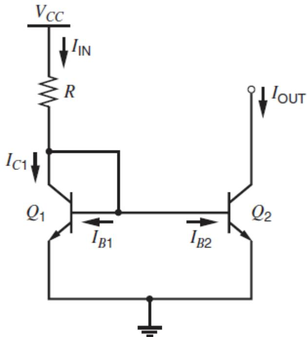
$$I_{IN} = \frac{V_{CC} - V_{BE1}}{R}$$
