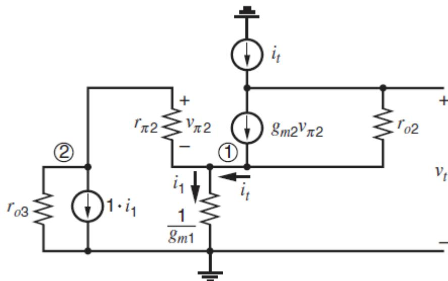
$$v_{\pi 3} = v_{\pi 1} \simeq i_1 / g_{m1}$$
