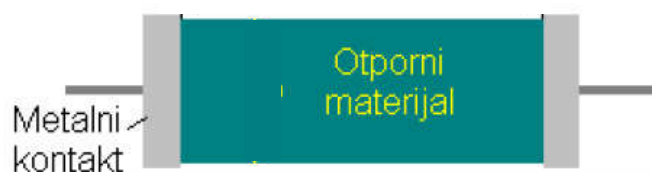
Poprečni presek ugljenog otpornika
