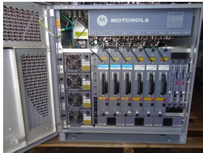
Pojačavači u predajnicima bazne stanice mobilne telefonije
