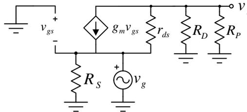
Parametri modela za male signale su  $g_m = \sqrt{2k_n I_D} = 2 \text{ mS}$  i  $r_{ds} = \frac{1}{\lambda I_D} = 50 \text{ k}\Omega$ .
