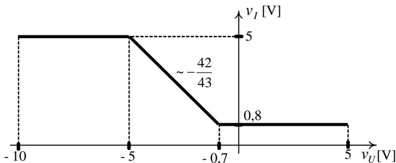
$$i_D = \begin{cases} 0 \text{ A, za } -0,7 \text{ V} < v_U < 5 \text{ V} \\ -43,25 \mu\text{S} \cdot v_U - 0,202 \text{ mA, za } -5 \text{ V} < v_U < -0,7 \text{ V} \\ -20 \mu\text{S} \cdot v_U + 0,086 \text{ mA, za } -10 \text{ V} < v_U < -5 \text{ V} \end{cases}$$
