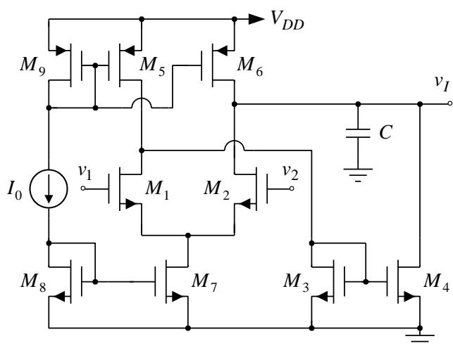
**4.** Parametri tranzistora u pojačavaču sa slike su:  $\mu_n C_{ox} = 110 \mu\text{A/V}^2$ ,  $\mu_p C_{ox} = 50 \mu\text{A/V}^2$ ,  $V_{TN} = 0,7 \text{ V}$ ,  $V_{TP} = -V_{TN}$ ,  $\lambda_n = 0,04 \text{ V}^{-1}$ ,  $\lambda_p = 0,05 \text{ V}^{-1}$ ,  $(W/L)_{1-9} = 50/1$ , dok je:  $V_{DD} = 1,5 \text{ V}$ ,  $I_0 = 100 \mu\text{A}$  i  $C = 5 \text{ pF}$ . Smatrali da je mirna radna tačka izabrana tako da su svi tranzistori u zasićenju.
