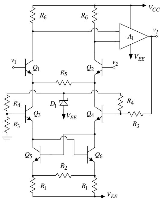
2. U instrumentacionom pojačavaču sa slike operacioni pojačavač se može smatrati idealnim, a poznato je:  $V_{CC} = -V_{EE} = 15V$ ,  $R_2 = 400\Omega$ ,  $R_3 = 10k\Omega$ ,  $R_4 = 100\Omega$ ,  $R_6 = 6,8k\Omega$ , svi tranzistori su identičnih karakteristika sa  $\beta_F = 200$ ,  $V_\gamma = V_{BE} = 0,7V$  i  $V_{CES} = 0,2V$ , a Zener dioda je idealna sa  $V_Z = 3,3V$ .
