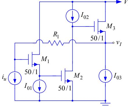
2. [10] Parametri tranzistora u pojačavaču sa slike su:  $\mu_n C_{ox} = 100 \mu\text{A/V}^2$ ,  $V_{TN} = 0,7 \text{ V}$  i  $\lambda_n = 0,04 \text{ V}^{-1}$ , dok je  $V_{DD} = 3,3 \text{ V}$ . Na slici je, pored svakog tranzistora, dat i odnos širine i dužine kanala. Odrediti struje strujnih izvora  $I_{01-3}$  i otpornost  $R_L$  tako da bude:
