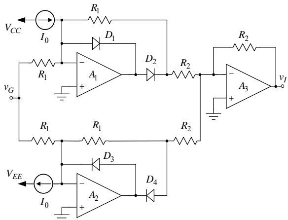
**2.** U kolu sa slike operacioni pojačavači se mogu smatrati idealnim i napajaju se iz baterija  $V_{CC} = 12 \text{ V}$  i  $V_{EE} = -12 \text{ V}$ , provodne diode imaju pad napona  $V_D = 0,6 \text{ V}$ , dok je:  $I_0 = 100 \mu\text{A}$ ,  $R_1 = 50 \text{ k}\Omega$  i  $R_2 = 10 \text{ k}\Omega$ .
