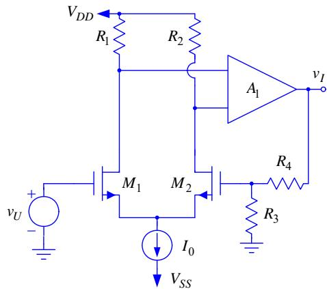
2. U kolu pojačavača sa slike parametri upotrebljenih tranzistora su:  $B = \mu_n C_{ox} (W / L) = 2 \text{ mA/V}^2$ ,  $V_T = 0,7 \text{ V}$  i  $\lambda \rightarrow 0$ , dok je:  $V_{DD} = -V_{SS} = 1,65 \text{ V}$ ,  $I_0 = 100 \mu\text{A}$  i  $R_1 = R_2 = R_3 = 10 \text{ k}\Omega$ ,  $R_4 = 90 \text{ k}\Omega$ . Ukoliko se drugačije ne naglasi, smatrati da je operacioni pojačavač idealan.
