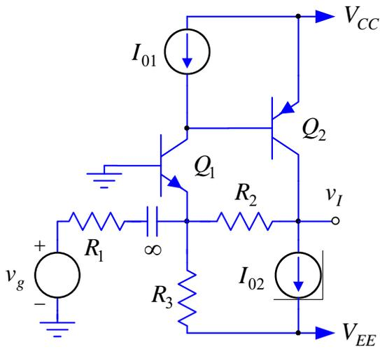
2. Parametri tranzistora u pojačavaču sa slike su:  $|V_{BE}| = 0,6 \text{ V}$ ,  $\beta_F = \beta_0 = 100$ ,  $V_A \rightarrow \infty$ , dok je:  $V_{CC} = -V_{EE} = 3 \text{ V}$ ,  $I_{01} = 100 \mu\text{A}$ ,  $I_{02} = 1 \text{ mA}$ ,  $R_1 = 1 \text{ k}\Omega$  i  $R_2 = 10R_1$ .
