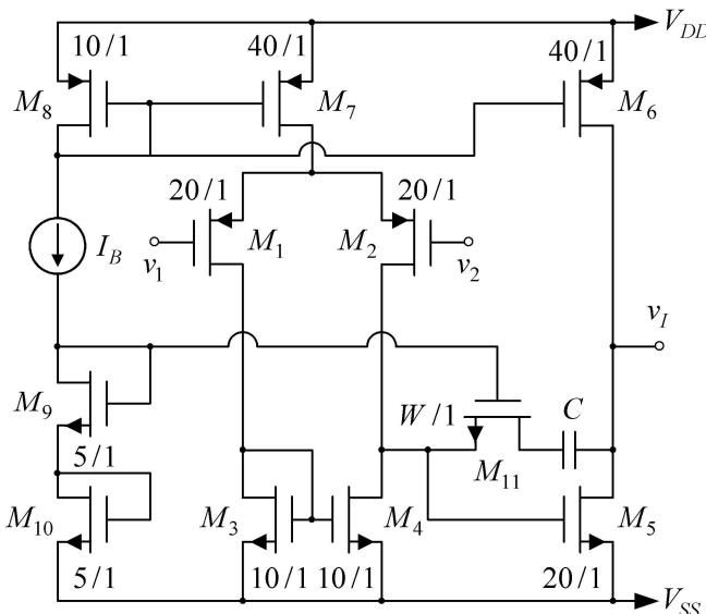
**4.** Parametri tranzistora u pojačavaču sa slike su:  $\mu_n C_{ox} = 110 \mu\text{A/V}^2$ ,  $\mu_p C_{ox} = 50 \mu\text{A/V}^2$ ,  $V_{TN} = 0,7 \text{ V}$ ,  $V_{TP} = -V_{TN}$ ,  $\lambda_n = 0,04 \text{ V}^{-1}$  i  $\lambda_p = 0,05 \text{ V}^{-1}$ . Na istoj slici je, pored svakog tranzistora, dat odnos širine i dužine kanala, dok je:  $V_{DD} = -V_{SS} = 2,5 \text{ V}$ ,  $I_B = 10 \mu\text{A}$  i  $C = 5 \text{ pF}$ .
