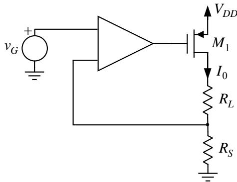
2. Parametri tranzistora u kolu sa slike su:  $\mu_p C_{ox} = 70 \mu\text{A/V}^2$ ,  $V_{TP} = -0,45 \text{ V}$ ,  $\lambda_p L = 0,08 \mu\text{m/V}$ ,  $W = 160 \mu\text{m}$  i  $L = 0.5 \mu\text{m}$ , dok je:  $V_{DD} = 1.8 \text{ V}$ ,  $R_L = 50 \Omega$  i  $R_S = 1 \text{ k}\Omega$ . Operacioni pojačavač se napaja iz jedne baterije za napajanje  $V_{DD} = 1.8 \text{ V}$ .
