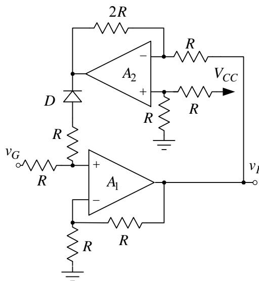
2. U kolu sa slike operacioni pojačavači se mogu smatrati idealnim i napajaju se iz baterije  $V_{CC} = 5\text{V}$ , dioda je idealna sa  $V_D = 0,7\text{V}$ , dok je  $R = 10\text{k}\Omega$ .
