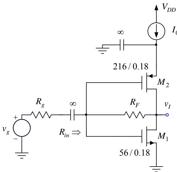
ekvivalentnog naponskog generatora termičkog šuma na ulazu pojačavača. Poznato je  $KT = 4 \cdot 10^{-21} \text{ J}$ .
