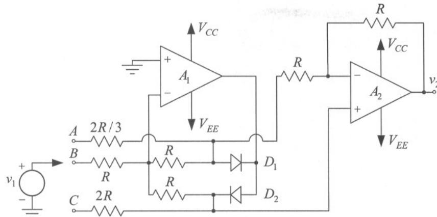
$V_{CC} = -V_{EE} = 12 \text{ V}$ . Diode imaju pad napona  $V_D = 0,6 \text{ V}$ , ostale karakteristike im se mogu smatrati idealnim, dok je  $R = 10 \text{k}\Omega$ .
