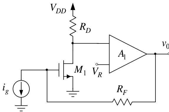
Kolo pojačavača sa slike se napaja iz baterije  $V_{DD} = 1.8 \text{ V}$ , operacioni pojačavač ima naponsko pojačanje  $a_l = 50$  i sve ostale karakteristike mu se mogu smatrati idealnim, parametri tranzistora su:  $W/L = 1.8 \mu\text{m}/0.18 \mu\text{m}$ ,  $\mu_n C_{ox} = 270 \mu\text{A/V}^2$ ,  $|V_T| = 0.45 \text{ V}$  i  $\lambda \rightarrow 0$ , dok je  $R_D = 3,9 \text{ k}\Omega$ .
