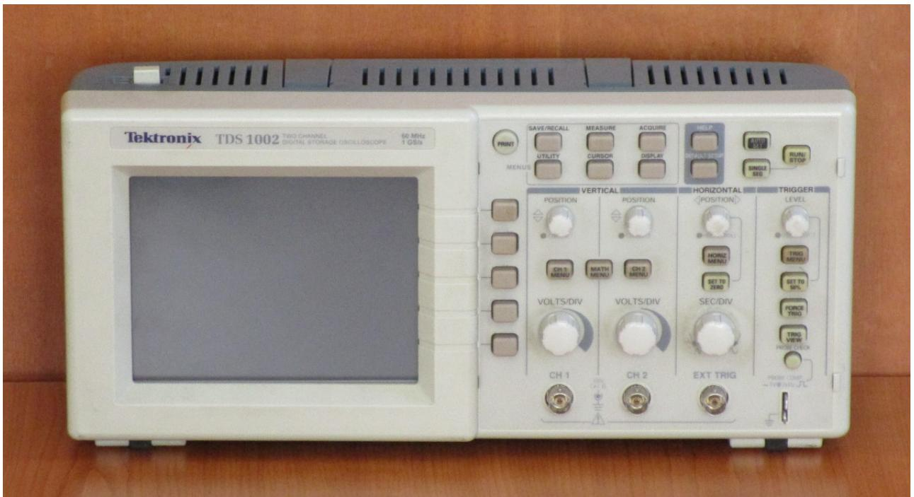
Slika 6: Osciloskop Tektronix TDS 1002.
