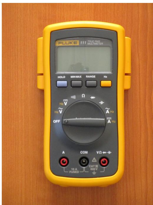
Slika 1: Multimetar Fluke 111.
