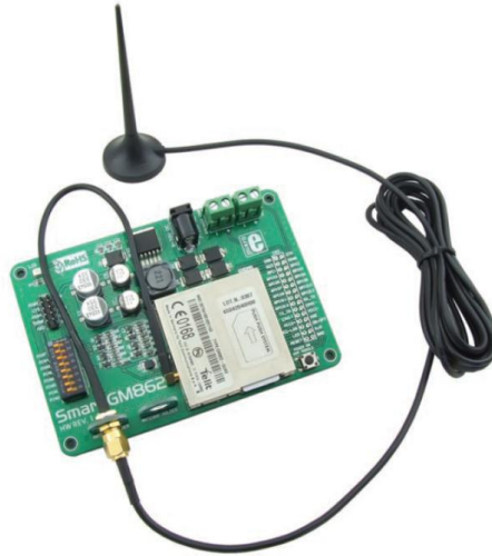
Slika 3. GSM/GPRS modem - Telit GM862-QUAD GSM na Smart GM862 ploči.
