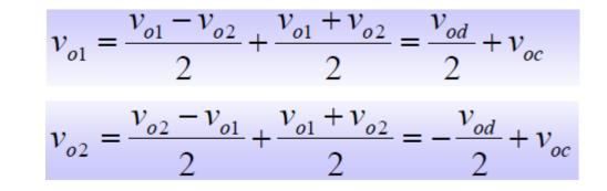
$$\begin{bmatrix} v_{od} \\ v_{oc} \end{bmatrix} = \begin{bmatrix} A_{dd} & A_{dc} \\ A_{cd} & A_{cc} \end{bmatrix} \begin{bmatrix} v_{id} \\ v_{ic} \end{bmatrix}$$
