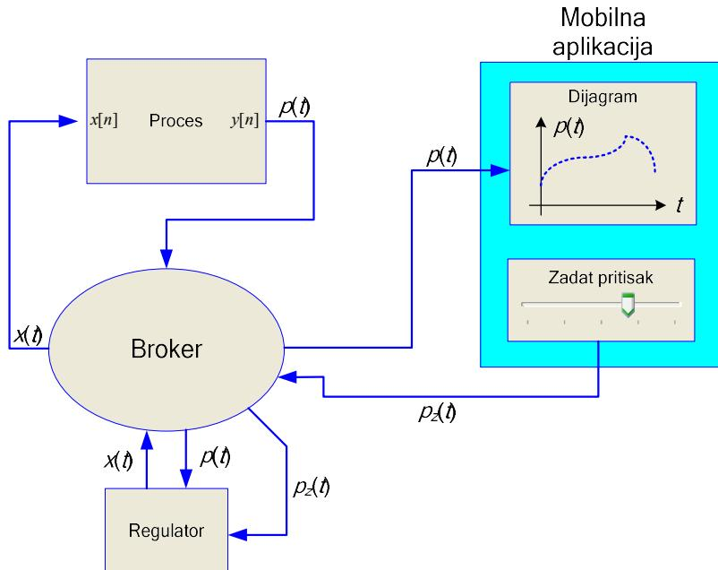
a) Industrijski proces je opisan diferencnom jednačinom koja modeluje sistem prvog reda sa vremenskom konstantom od 10s i pojačanjem 1:
